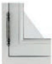
**Les fenêtres dites à « rive droite »** : dans cette conception caractéristique des menuiseries bois à l'ancienne, les ouvrants et les dormants sont alignés sur le même plan. Plus complexe, sa fabrication nécessite un réglage sur mesure en atelier. Les fenêtres à rive droite conviennent parfaitement aux bâtiments classés ou aux demeures traditionnelles. Pour les fenêtres à rive droite, le ferrage est assuré par des paumelles entaillées.
